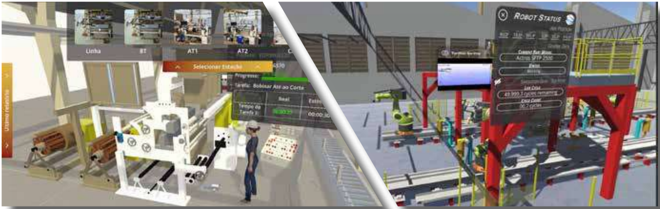
Gémeo Digital para a produção de transformadores na EFACEC (Porto), com foco na rastreabilidade em tempo real e na integração IT/OT com sistemas industriais e ERP
