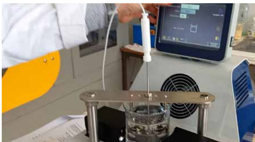
Ensaio de determinação da temperatura de amolecimento do betume
