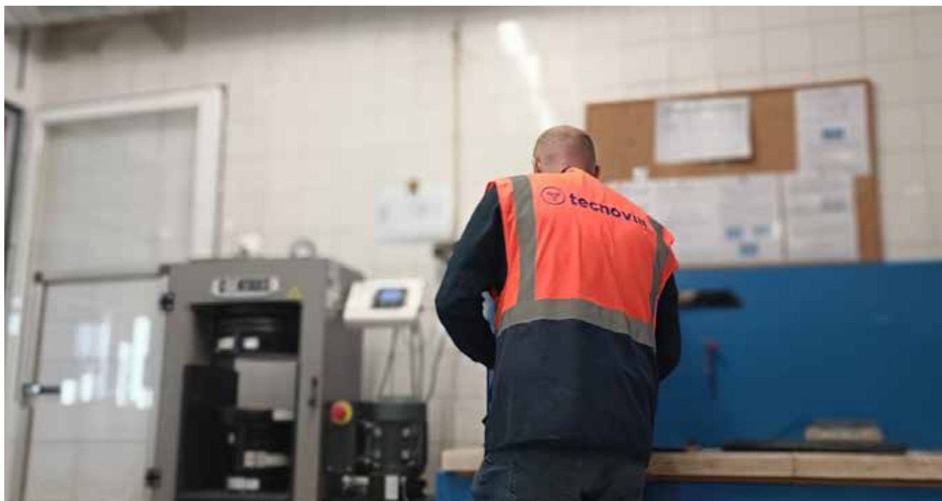
Ensaio de resistência à compressão de provetes de betão
