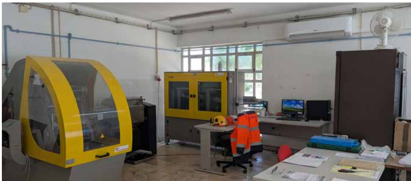
Equipamentos de ensaios de avaliação de desempenho de misturas betuminosas
