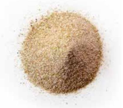
seus contaminantes que nos permitem selecionar as operações unitárias que assegurem a sua separação de forma eficaz e eficiente. Como etapas principais do processo destacamos: receção e caracterização dos resíduos de vidro; seleção granulométrica; separação magnética; separação de leves; deteção ótica. O processo é monitorizado em contínuo pelo controlo de qualidade.
