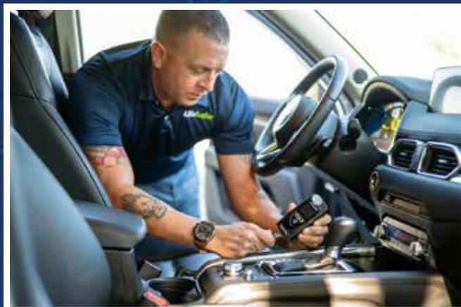
**O QUE É:** Sistema Bloqueio Automático da Ignição em presença de Álcool
