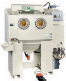
Máquinas manuais de jateamento, a seco ou húmido, de várias dimensões e filtro incluído. Granalhadoras compactas de funcionamento autónomo e com separação dos resíduos através de ciclone estático.
