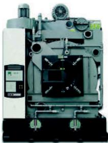
Máquinas para o desengorduramento com dissolventes ou álcool modificado em circuito fechado e segundo as normas VOC/13/99. Funcionamento por imersão com ultrassons, aspersão e vaporização. Secagem auxiliada pelo vácuo.
