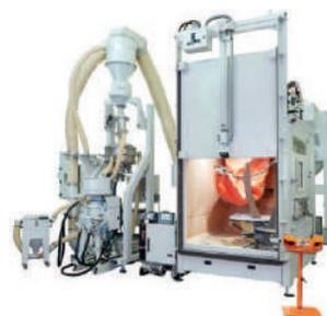
Instalações robotizadas à medida, em função do processo de jateamento ou shoot peening a realizar.
