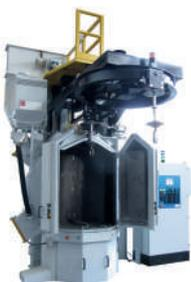
Granalhadoras automáticas de turbinas, para tratamento de cargas suspensas em bastidores, ou colocadas na mesa para peças de grandes dimensões. Movimentos de rotação e oscilação e dispensa obra civil.
