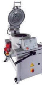
Máquinas de secar peças metálicas ou de extração de óleo por centrifugação. Descarga completa por basculamento. Capacidade: 70 kg de carga.
